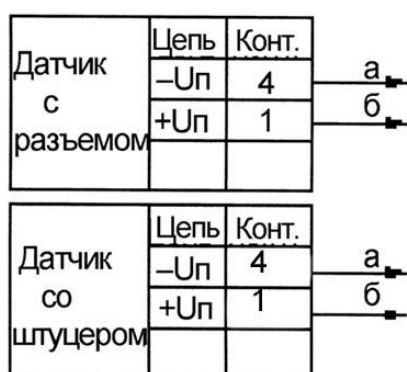
Параметры линии связи: R_n \leq 25 \text{ Ом} ; C_k \leq 0,25 \text{ мкФ} ; L_k \leq 1,0 \text{ мГн}
